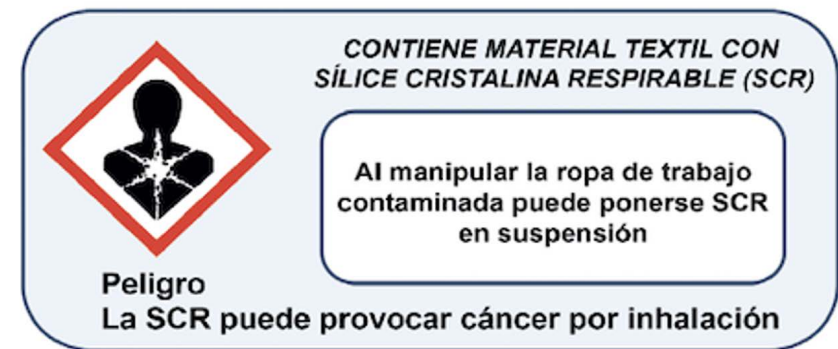
Figura 9. Propuesta de etiqueta para señalizar recipientes que contienen ropa de trabajo con SCR (INS).
