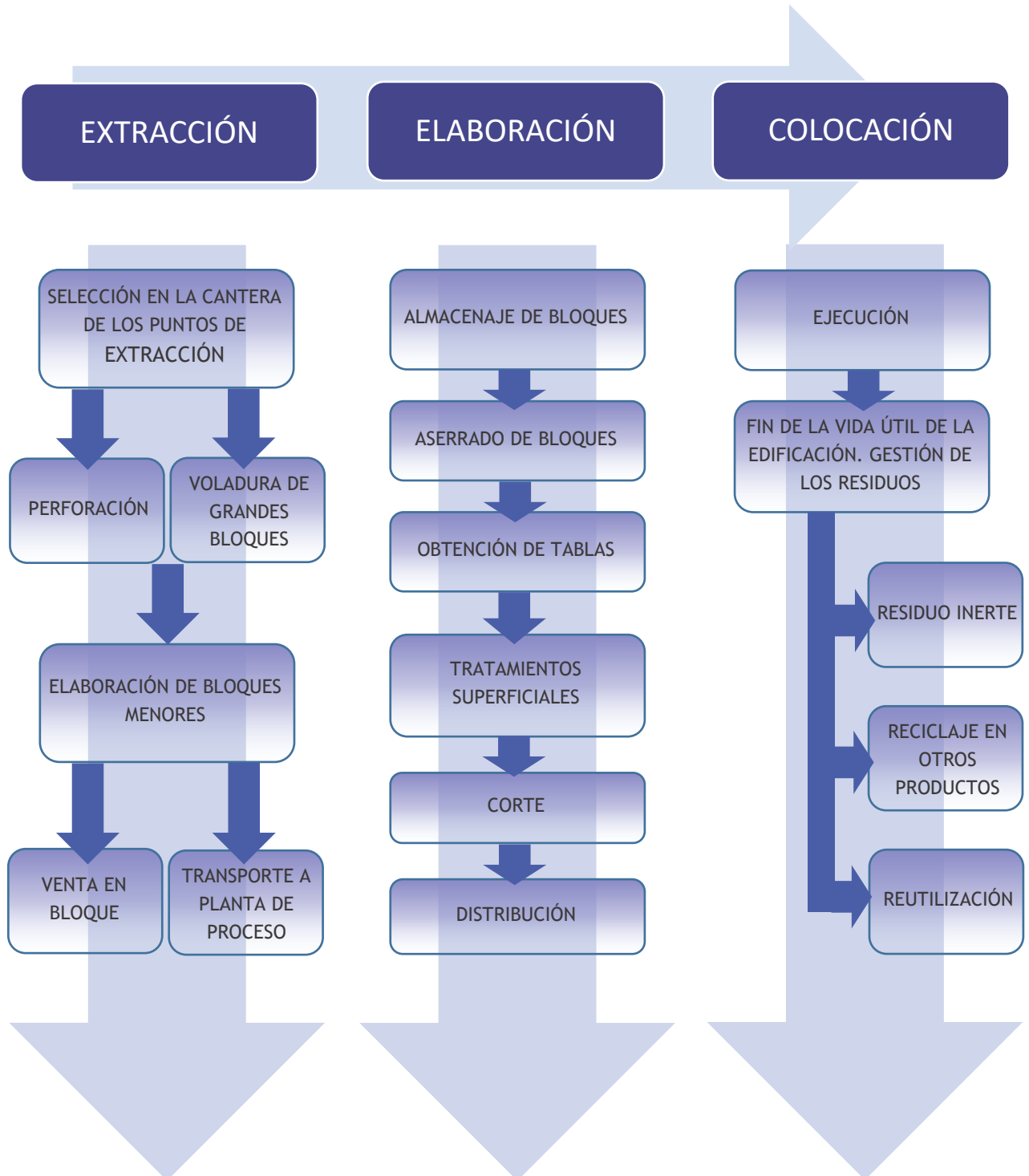
Gráfico 2: Cadena de valor de la piedra natural. Fuente: Cluster Piedra. Elaboración propia.
