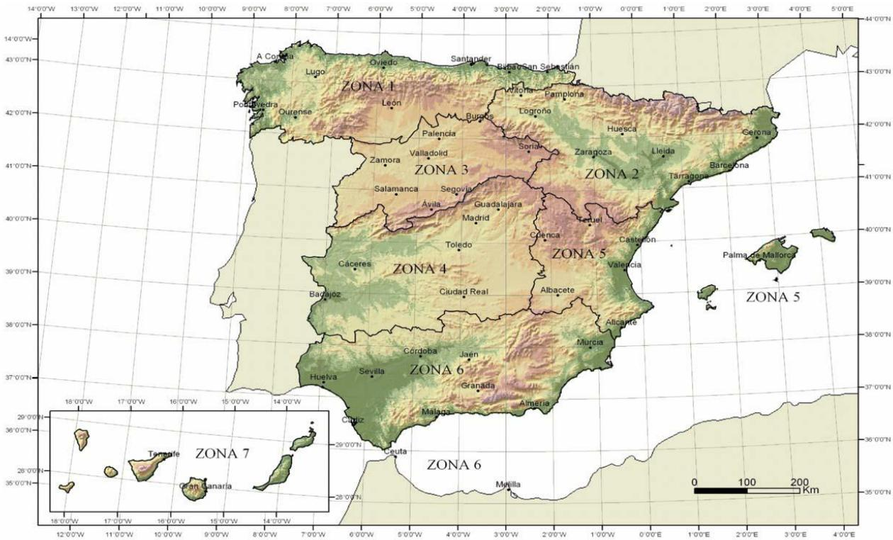
Figura 1. Zonas climáticas de invierno (Tomado del CTE DB SE-AE, Anejo E, figura E.2).
